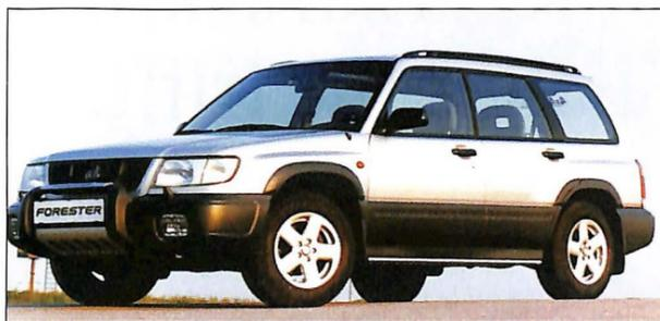
Der Forester verfügt wie alle Subaru-Modelle über den bewährten, horizontal gelagerten 16V-Boxermotor, in diesem Fall mit 2,0 Liter Hubraum, der durch seine niedrige Bauweise und geringe Länge einen tiefen Schwerpunkt aufweist, was das Fahrverhalten des Fahrzeuges sehr positiv beeinflusst. Angetrieben wird die neue Fahrzeugklasse von Subaru von 122 Pferden (90 kW), die mit Benzin zu füttern sind.
