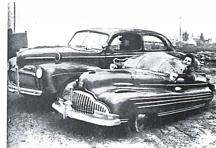
Auch Amerika beschäftigt sich mit dem Bau von Kleinwagen. Wie die Karosserie zeigt, braucht sich die zum Vergleich hingestellte große Limousine des kleinen Knirpses nicht zu schämen. Der Name des Kleinautos ist „Hollywood Strak“. Es ist 1'20 m hoch, 3 m lang, hat aber zum Unterschied von anderen Kleinwagen nicht weniger als 100 PS!
