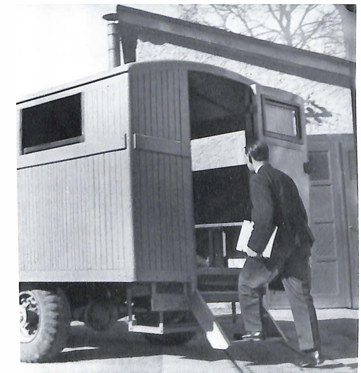
Eine herausklappbare Stiege ermöglicht es, leicht und bequem in das Innere des Wagens zu gelangen
