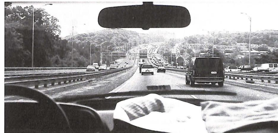
H.O.V. (High occupied vehicles only): eine Autobahn am Stadtrand von Washington; die 2 mittleren Fahrstreifen sind nur zur Hauptverkehrszeit geöffnet und dürfen nur von Fahrzeugen benützt werden, mit mindestens 3 Insassen
