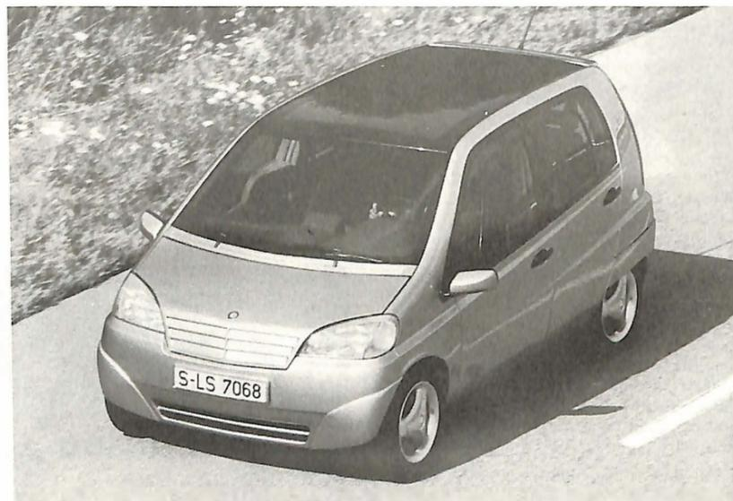
Mit dem „Vision A 93“ kreiert Mercedes-Benz eine neue, kompakte Fahrzeugklasse. Der Technologieträger unterscheidet sich von bisherigen Kompaktmodellen, weil er trotz der Außenabmessungen eines Kleinwagens die Platzverhältnisse und die Sicherheit einer Limousine bietet. Ein zukunftsweisen-
