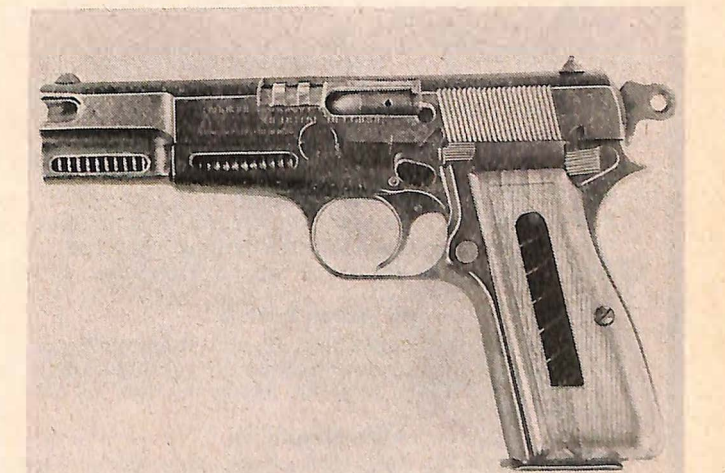
Das unter der Leitung Bergmosers für den Unterricht hergestellte Schnittmodell der Pistole M 35
