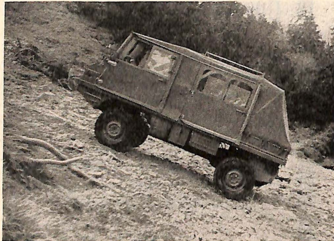
Auffahrt über eine Schotterriese mit einer 30prozentigen Steigung
