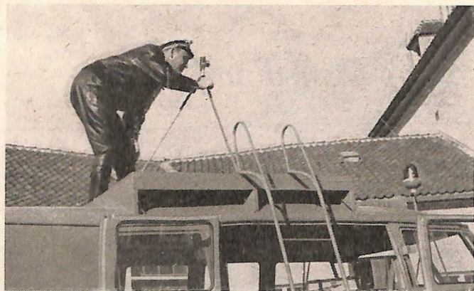
Eine am Dach des Einsatzwagens montierte Plattform ermöglicht das Fotografieren von oben
