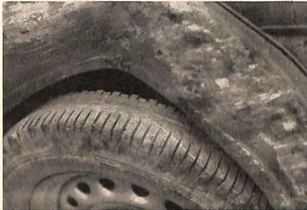
Abb. 4: Nahaufnahme des rückwärtigen rechten Reifens des in Abb. 3 gezeigten Personenkraftwagens. Der schlechte Reifenzustand ist deutlich zu erkennen. Enderfolg — drei Verkehrstote
