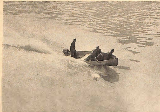
Der Wendekreis des leicht beweglichen Bootes beträgt zirka 5 bis 6 m bei voller Fahrt
