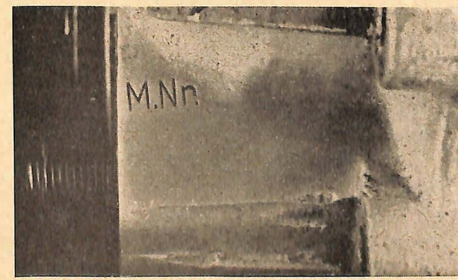
Bild 2: Die abgeschliffene Stelle an einem Motorrad, an der die Motornummer entfernt wurde, vor der Aetzung
