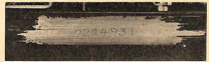
Bild 1 a: Die rekonstruierte Fabriknummer nach der Aetzung
