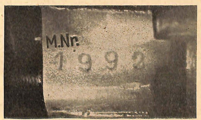
Bild 2 a: Dieselbe Stelle nach der Aetzbehandlung. Die getilgte Nummer ist zur Gänze zum Vorschein gekommen
