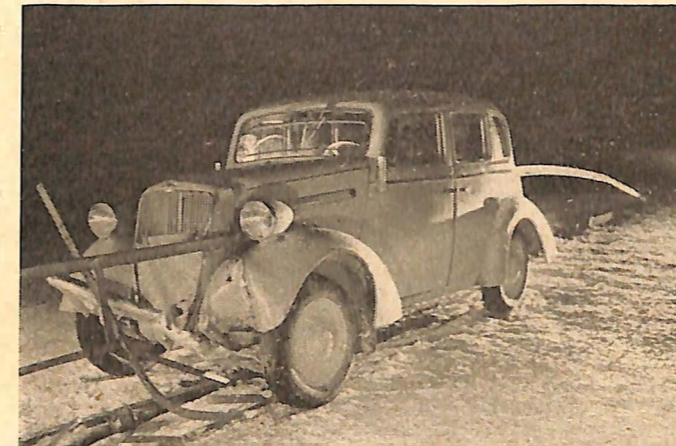
Vorderansicht des durchstoßenen Personenkraftwagens nach dem Unfall. Der Wagen wurde von der oberen Geländerstange in Kotflügelhöhe auf der linken Seite aufgespießt
