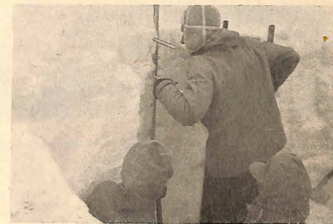
Erster Lehrgang für Beobachter des Lawinenwarndienstes im März 1953. Nach Aufnahme des Rammprofils wird entlang der Rammsonde in einem Schurfgraben die Temperatur der Schneedecke gemessen. Photo: K. Meusbürger
