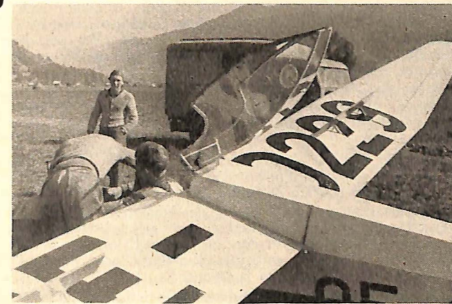
CE-0229 "Zeller Spatz". Der Flugzugführer wird am Sitz festgeschnallt. Die Bremsklappen an den Tragflächen sind ausgefahren
