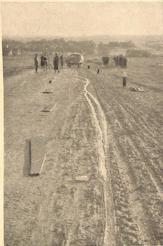
Die Unfallstelle mit der Fahr- und Bremsspur. Die linke Spur stammt vom Vorder- und die rechte vom Hinterrad, ein Zeichen, daß Patrouillenleiter Huber aus dem aufgeweichten Boden herausfahren wollte, dabei jedoch infolge Bremsbetätigung ins Schleudern und mit dem Motorrad zum Sturze kam
