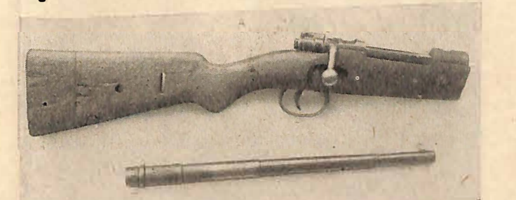
Die auseinandergenommene Waffe des Wilderers Josef N. aus Schw. Kolben, Verschluss und Abzug. Darunter: Lauf mit selbstangefertigter Visiereinrichtung
