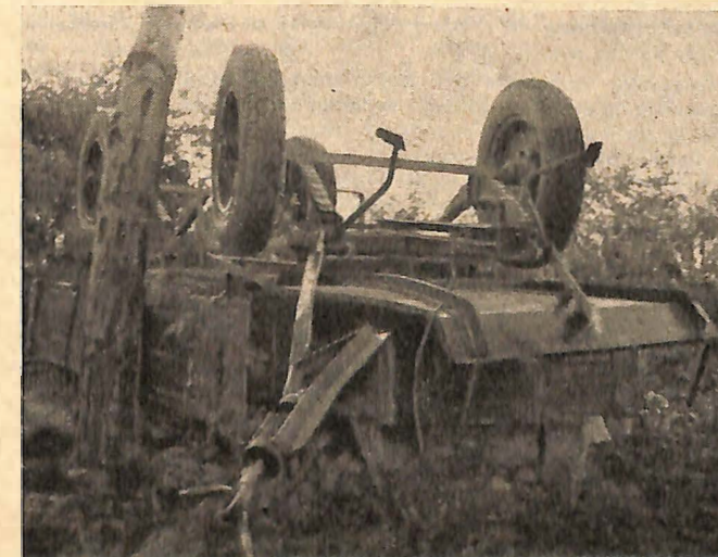
Vollkommen zertrümmerter Anhänger, der sich durch Ueberladung vom Lastkraftwagen losriß.
