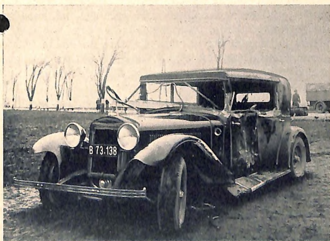
Das schwer beschädigte Auto. Die argen Beschädigungen lassen erkennen, daß das Auto den Wagen von rück-seitwärts erfaßt hat. Die ersten Spuren der Gewalteinwirkung befinden sich am linken vorderen Kotflügel und wurden durch Kreideanstrich deutlich gemacht.
