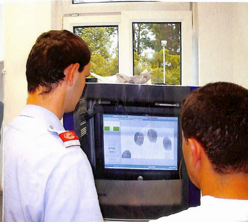
Am Eurodac Gerät werden Fingerabdrücke abgenommen, gespeichert und mit den Daten einer bestehenden Evidenz verglichen.
