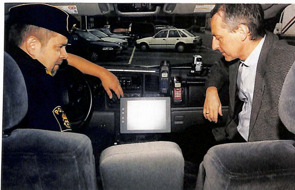
Ein Chevrolet-Van der Verkehrspolizei, ausgestattet mit Computer, Mobiltelefonen für verschiedene Handy-Netze, Video-Digital, Cd-Brenner usw.
