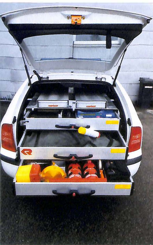
Dienstfahrzeug mit der eingebauten Transportbox
