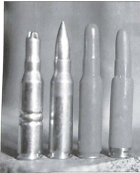
V.l.n.r.: Platzpatrone (Messing), scharfe Patrone 7,62 x 51 mm (Nato), Platzpatrone, Übungspatrone.
