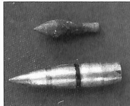
Geschöß und gehärteter Stahlkern.
